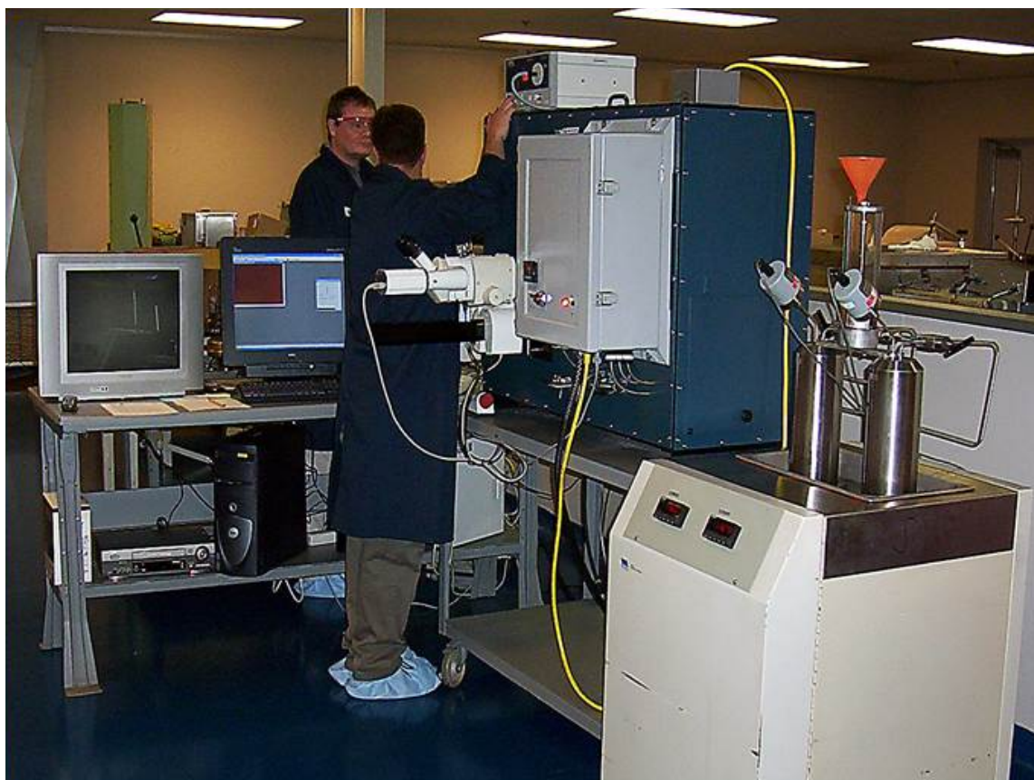
Установка визуализации флюида при пластовых условиях PFI-200
