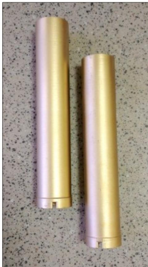
Также каждая коронка может быть укомплектована системой подачи смазочно-охлаждающей жидкости (вертлюг). Совместимы с водой, керосином, солевыми растворами.
