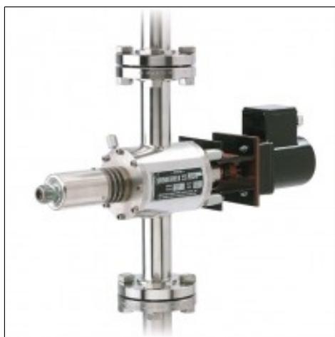
**Универсальный поточный ротационный вискозиметр ТТ-100** создан для проведения непрерывного мониторинга и контроля вязкости в замкнутых, полностью заполненных жидкостью системах при давлениях выше и ниже атмосферного. Вискозиметр устанавливается на основной или обводной трубе с помощью собственных фланцев, что позволяет проводить очистку или изменение диапазона измерения без извлечения вискозиметра из трубопровода.
